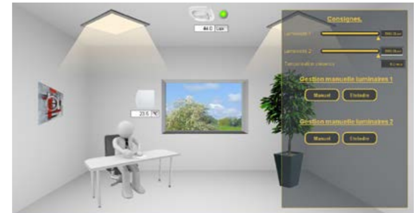
Fig. 3 Pilotage des luminaires par GTC
